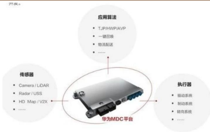
图表：MDC计算平台包括平台硬件、平台软件服务、功能软件平台、配套工具链及端云协同服务，支持L2+到L5的平滑演进
